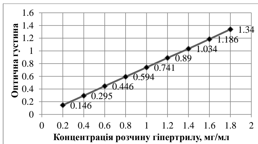
Рис. 4.9. Лінійна залежність оптичної густини від концентрації розчину при \lambda=258 нм
