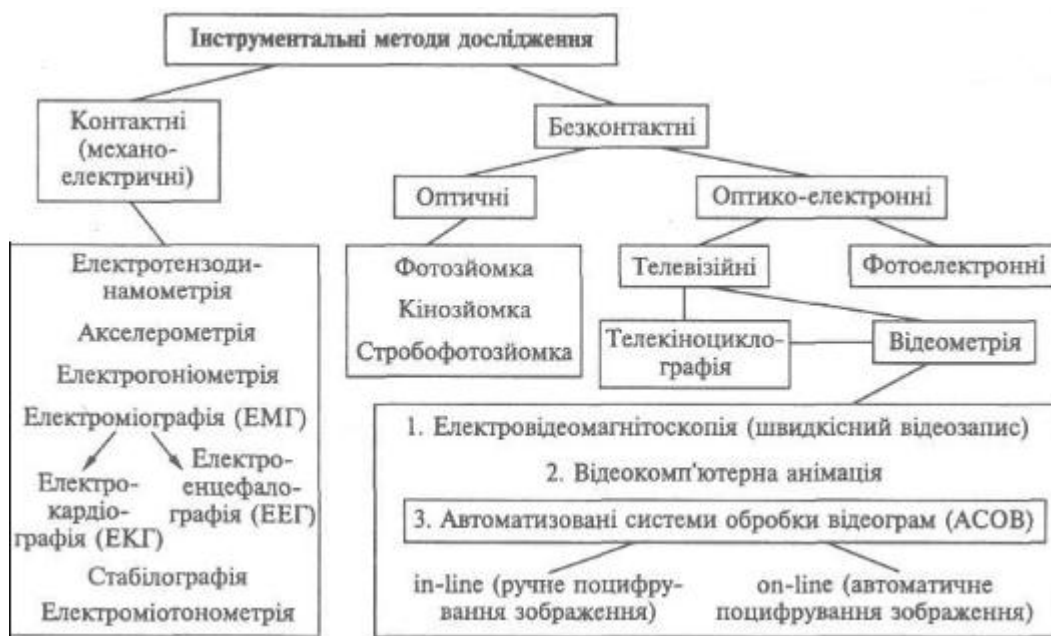
Рис. 2. Класифікація інструментальних методів вимірювання кількісних характеристик рухів
