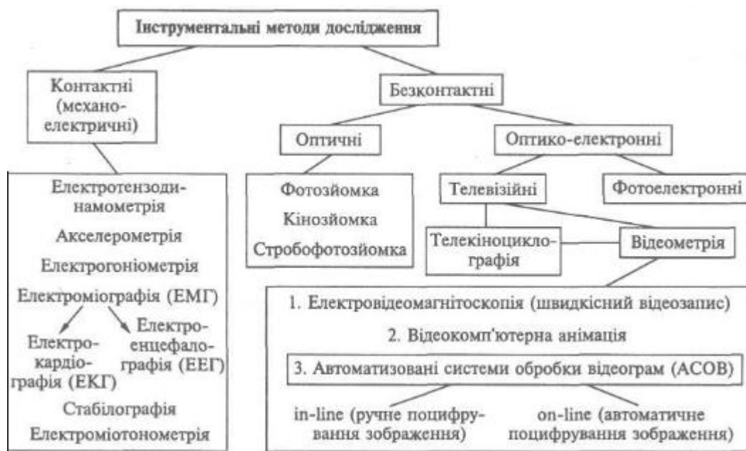
Рис. 2. Класифікація інструментальних методів вимірювання кількісних характеристик рухів.
