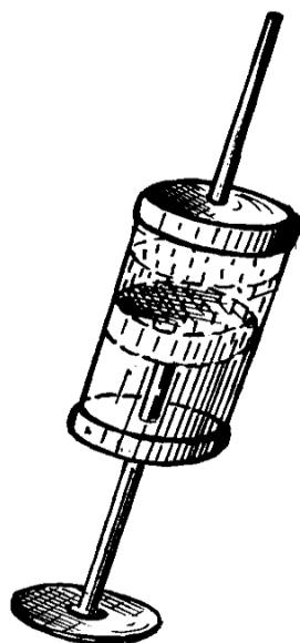
Рис. 3. Шприц Жанне для определения концентрации \text{CO}_2 по Д. В. Прохорову
