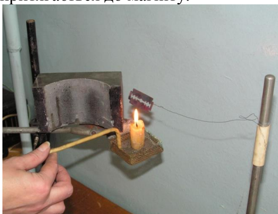
Рис. 1. Демонстрація точки Кюрі при вивченні курсу «Фізика» за темою лекції «Магнетизм»
