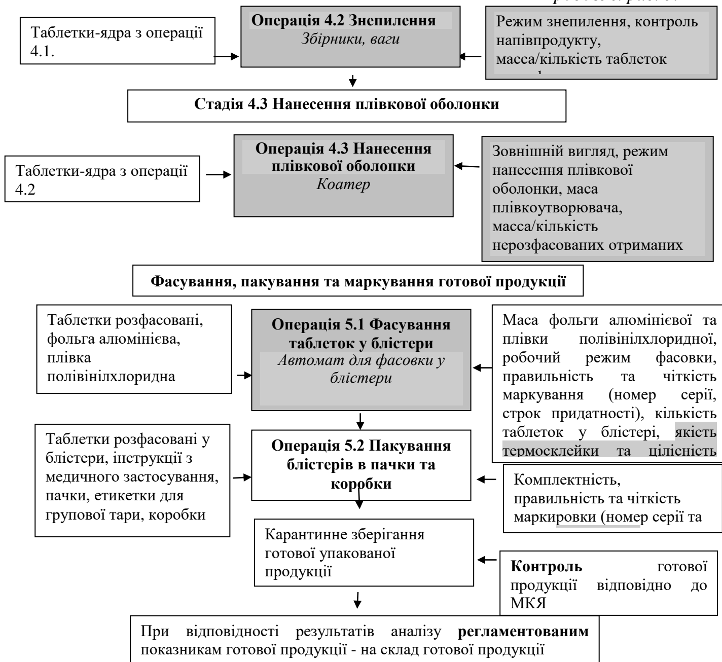
Рис. 5.21 Технологічна схема виробництва таблеток, вкритих плівковою оболонкою, ГАМК з морфолінію тіазотатом методом вологої грануляції (сірим кольором відмічені критичні стадії і критичні точки контролю в процесі виробництва)
