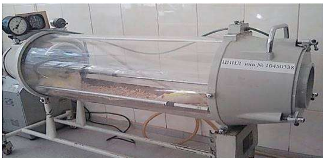
Рисунок 2.2 – Герметична барокамера для відтворення гіпобаричної гіпоксичної гіпоксії
