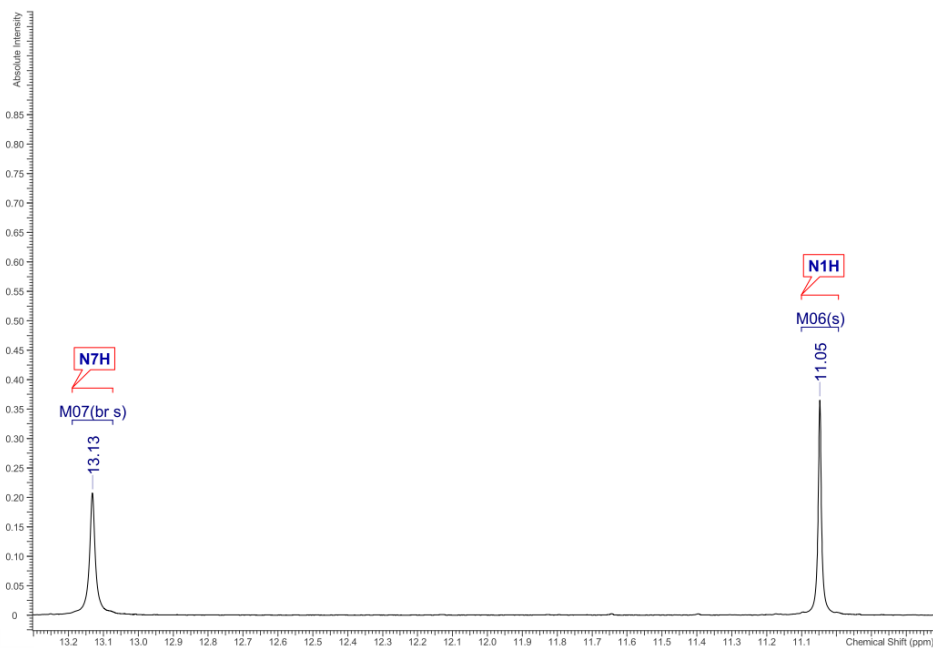
Рис. 2.4. Слабопольний фрагмент ^1\text{H} ЯМР-спектру 3-бензил-8-пропілксантину (2.3)
