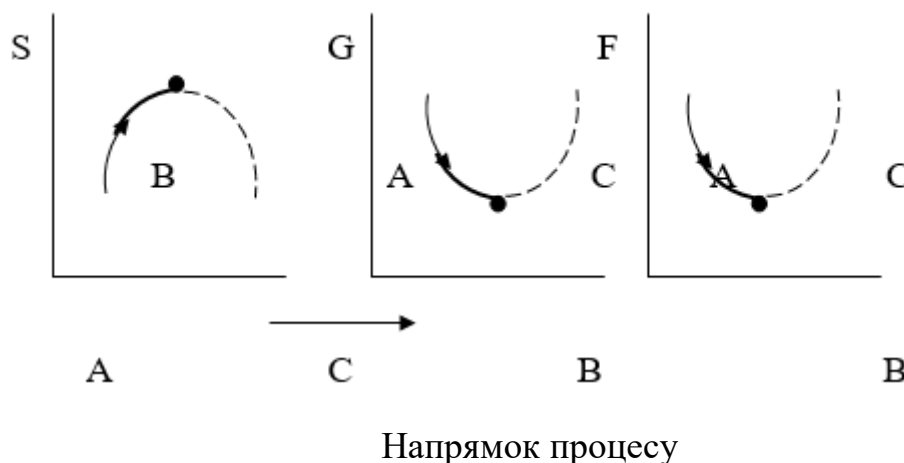
Рисунок 4.2. Змінення ентропії, енергії Гіббса та енергії Гельмгольца при проходженні процесу (Медична хімія / під ред. проф. В.О. Калібабчука, Київ, 2013)
