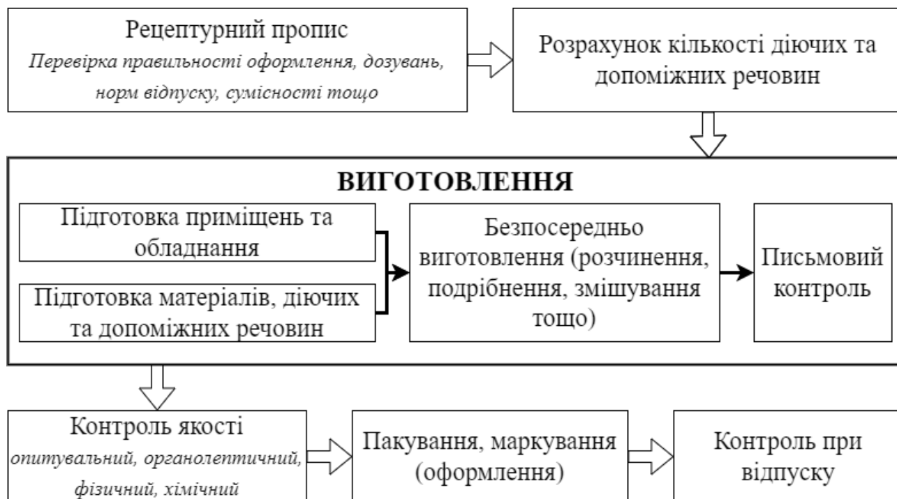
Рис. 5.1 Загальна схема виготовлення ЕЛЗ [джерело: власна розробка]
