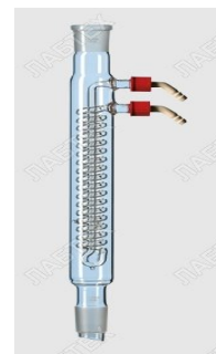
Рис. 89. Холодильники: а — кульковий холодильник; б — холодильник Лібіха; в — холодильник Дімрота
