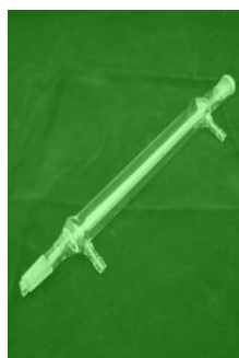
Рис. 89. Холодильники: а — кульковий холодильник; б — холодильник Лібіха; в — холодильник Дімрота
