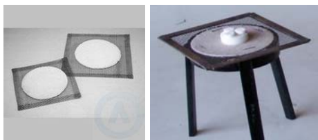
Мал. 79. Нагрівання через азбестову сітку.
