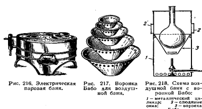
Мал. 82. Принцип дії воронки Бабо.
