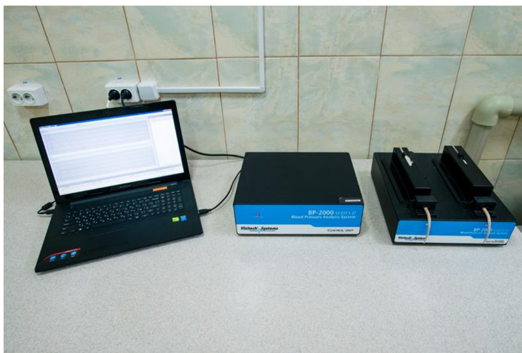
Рисунок 2.2 – Система неінвазивної реєстрації артеріального тиску BP-2000 із одномоментним вимірюванням АТ у двох щурів контрольної групи.
