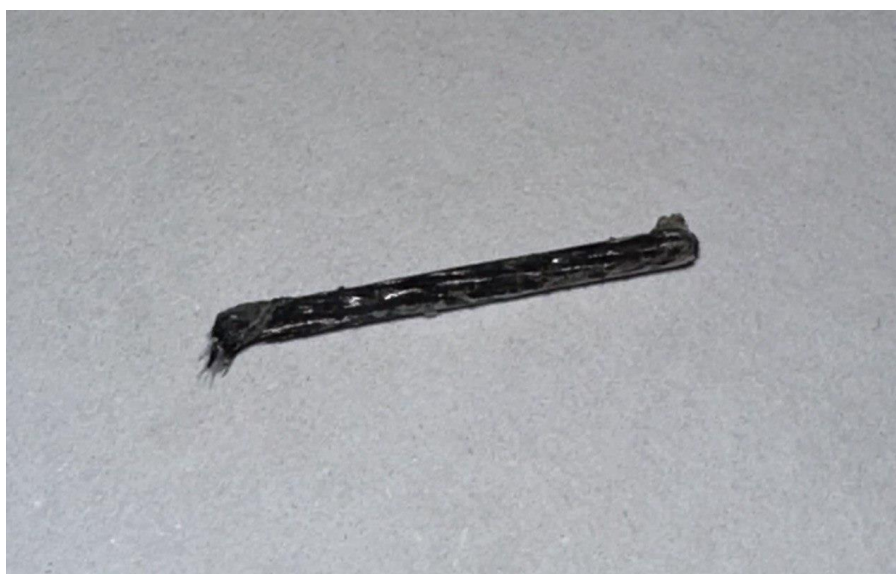
Рисунок 2.9 – Штифт з вуглецевого композитного матеріалу для інтрамедулярного остеосинтезу.
