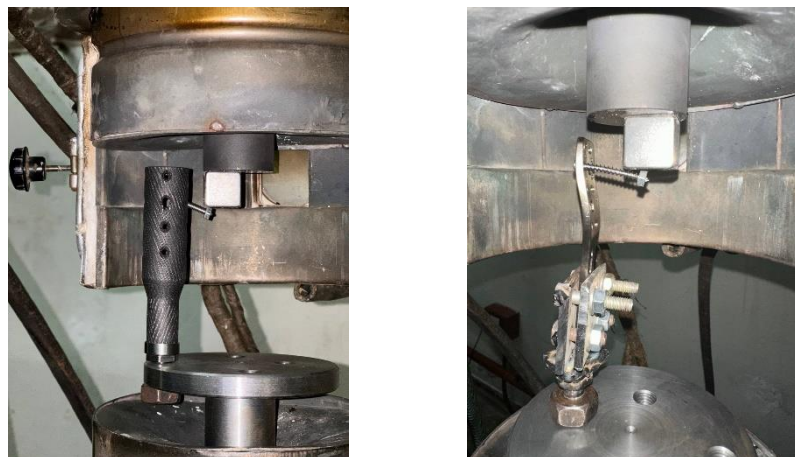
Рисунок 3.2 – Робоча зона установки для випробування на консольний згин з встановленим імплантатом з вуглецево-композитного матеріалу (а) та титанового сплаву (б).
