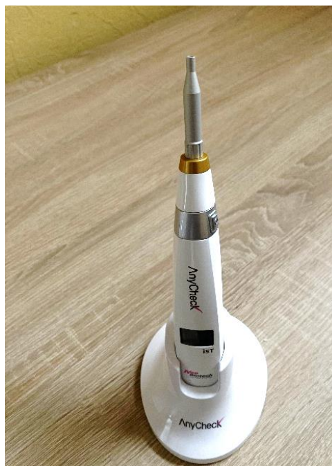
Рисунок 2.12 - Прилад для частотно-резонансного аналізу стійкості імплантату.
