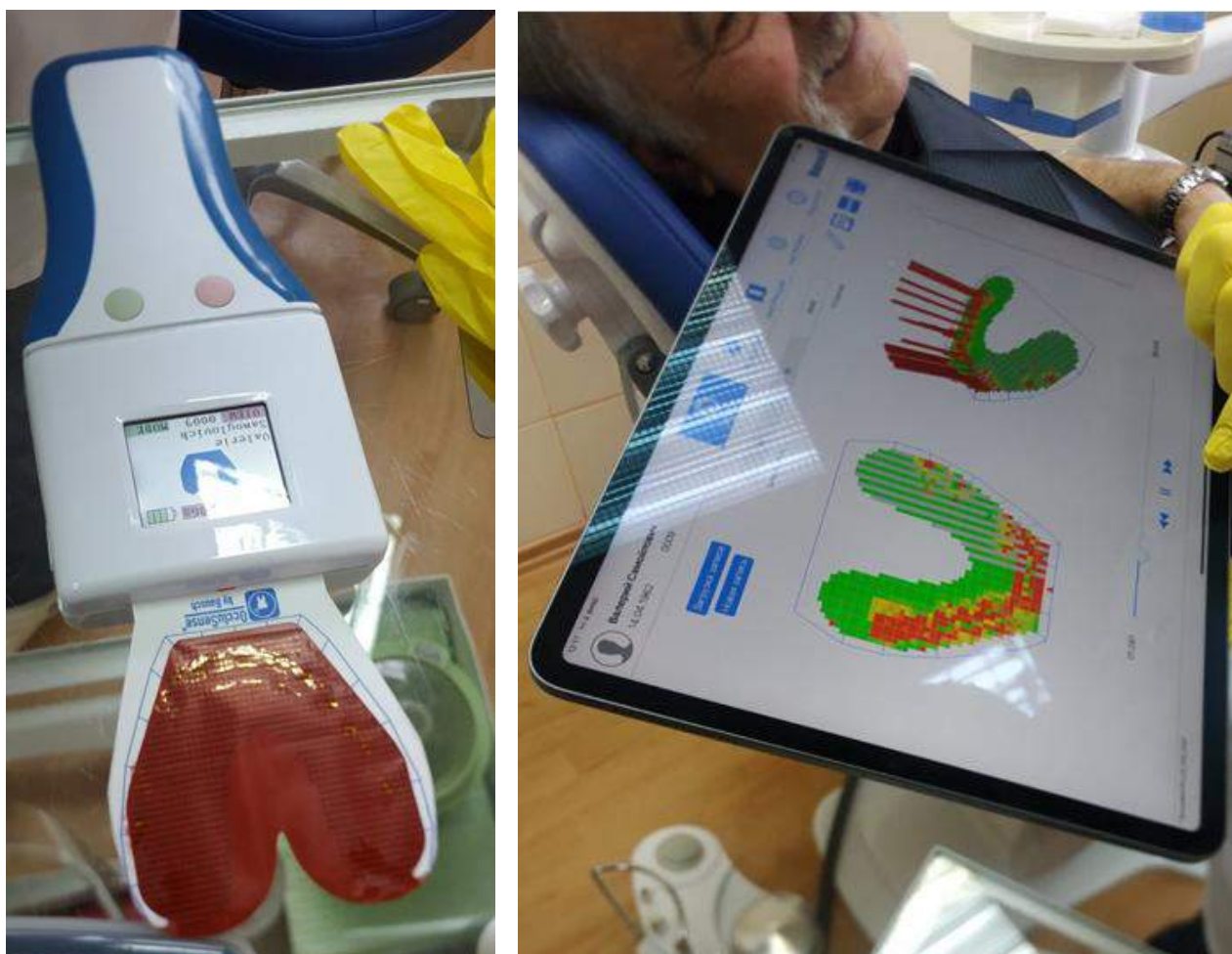
Рисунок 2.11 Методика цифрової реєстрації розподілу оклюзійного тиску OccluSense by Vausch.
