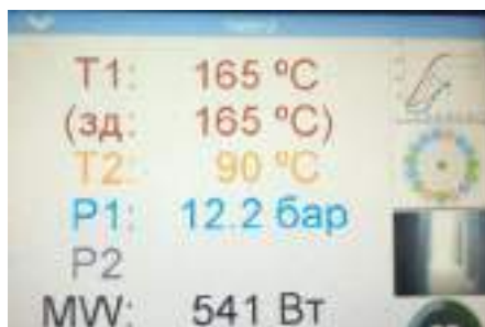
Рис. 2.19. Умови проходження мікрохвильового синтезу 3-(R-тіо)-5-(тіофен-2-ілметил)-4H-1,2,4-триазолів (2.82-2.85) та 3-((R-тіо)-5-(тіофен-2-ілметил)-4H-1,2,4-триазол-4-амінів (2.86-2.88)
