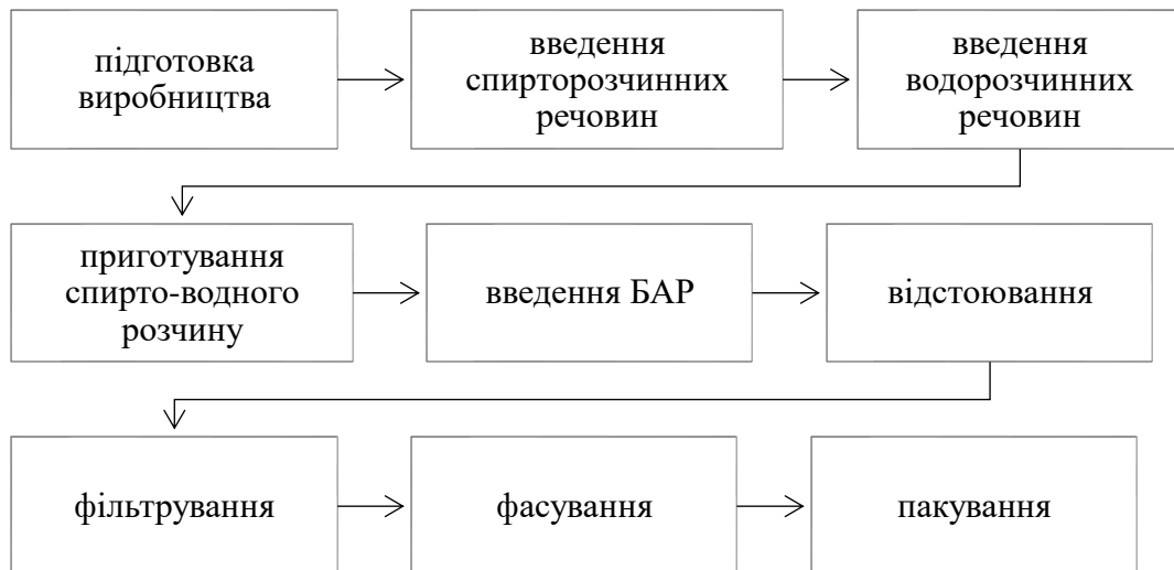
Рис. 6.7. Технологічний процес готування лосьйонів [джерело: власна розробка]
