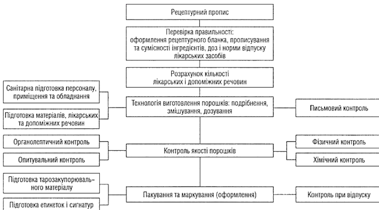
Рис. 1.3. Блок-схема технології та контролю якості порошків [джерело: 1]
