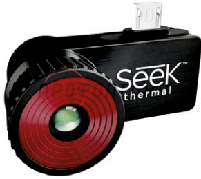
Рис. 1. а: Тепловізор Seek Thermal CompactPRO Android USB-C; б: кріплення тепловізора Seek Thermal CompactPRO до мобільного телефону; в: виконання інфрачервоної термографії, застосовуючи тепловізор Seek Thermal CompactPRO.
