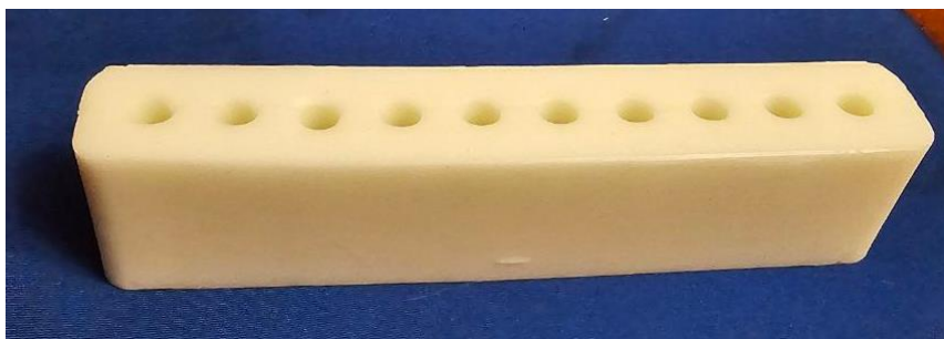
Рис. 1 Силіконова форма для виливання супозиторіїв багаторазового використання
