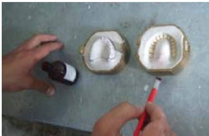
Рисунок 37. Нанесение изоляционной жидкости
