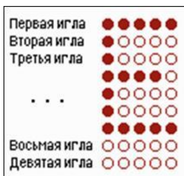
Рис. 32. Символ матричным принтером формируется на основании матрицы.
