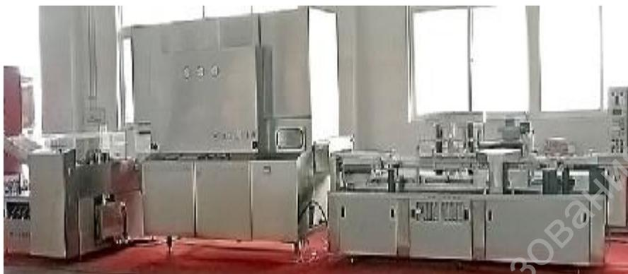
**Рис. 14 Линия розлива / укупорки для ампул и флаконов**
