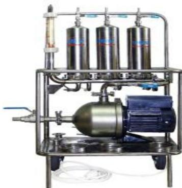
**Рис.4 Установка фильтрации УПФ.Р3 (1x250/1x250/1x250)-0,5**
