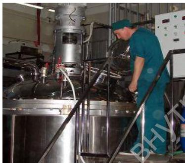
**Рис. 6 Линия для производства шампуней и пеномоющих средств, варочный комплекс «МОДУМ».**
