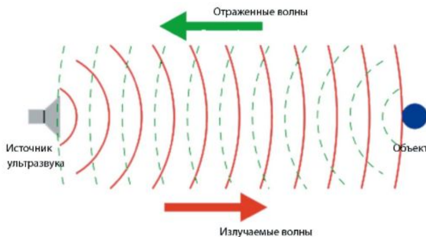
Мал. 54. Схема принципу роботи ультразвукового діагностичного апарату.
