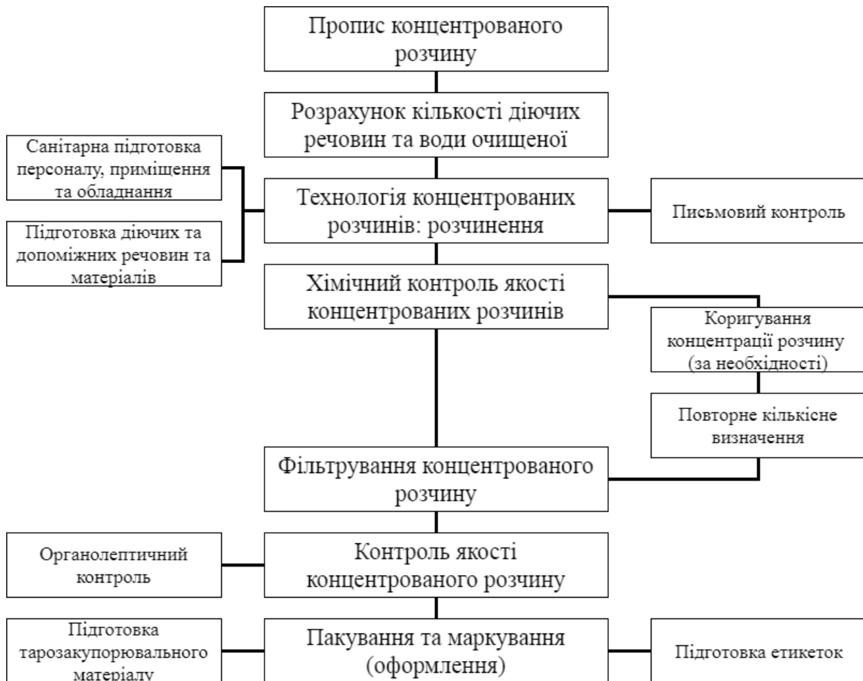
Рис. 20. Принципова технологічна схема виготовлення та контролю якості концентрованих розчинів
