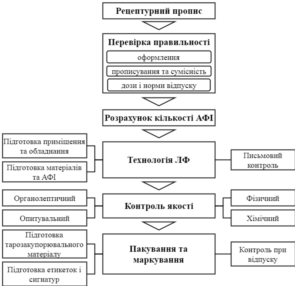
Рис. 19. Принципова схема виготовлення ЕЛЗ
