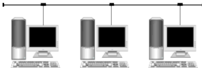
Рис. 2. Фізична топологія «Шина»
