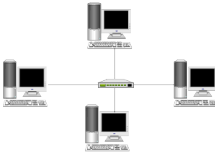
Рис. 4. Фізична топологія «Зірка»
